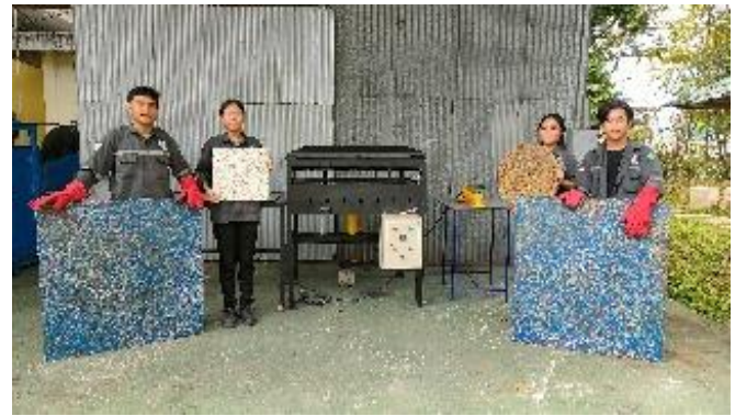
Gambar 3. Mesin sheet press dan hasil cetakan lembaran plastic
