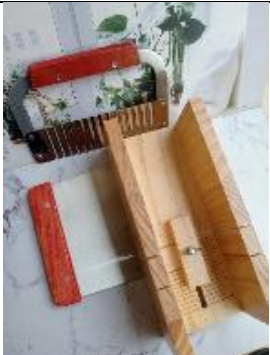
Gambar 9. Alat potong sabun
