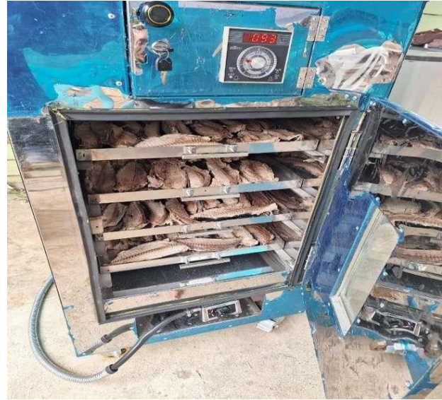
Gambar 7. Uji Coba Penggunaan Oven Pengering kapasitas 20 Kg
