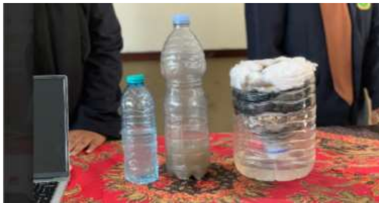
Gambar 4. Visualisasi air sebelum dan sesudah dilakukannya filtrasi
